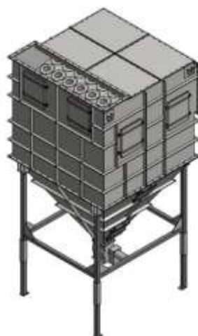
5.2. attēls. Multiciklona iekārtas piemērs 16
